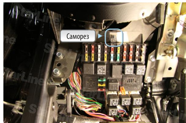
Фото 2.2. Саморез монтажного блока
