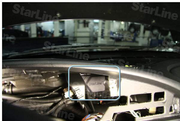
Фото 6.1. Блок сигнализации (общий вид)
