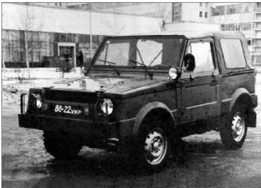
Образец третьей серии, доработанный испытателями. Уменьшен передний воздухозаборник, на дверях введены "форточки" – прообраз серии 400.
