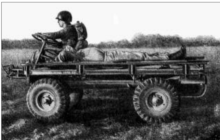
Его натовский прототип – "Виллис М274" ("механический мул"). В отличие от ТПК, не плавает.
