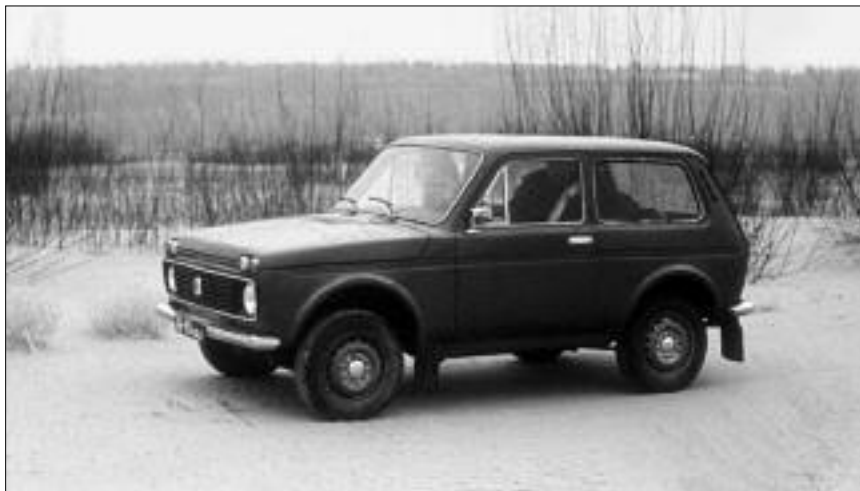
1975 год. "Нива" с двигателем от "Москвича-412". Хорошо виден удлинённый передок.
