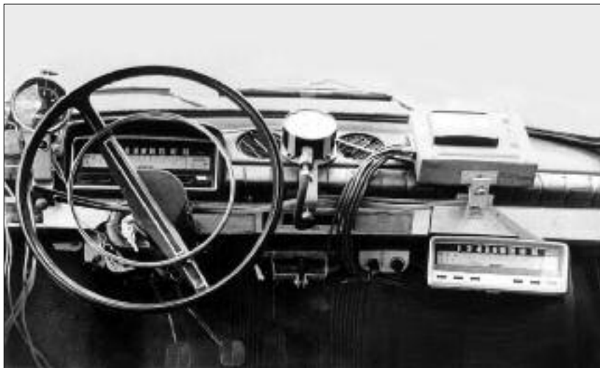
Панель приборов Э1101, оборудованная дополнительной аппаратурой. Слева направо: тахометр, манометр системы охлаждения (помните тот бачок-гранату?), электротермометр и дополнительный щиток приборов.
