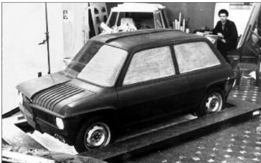
Две половинки полноразмерного макета Э1101. Слева – вариант Ю.Данилова, справа – В.Ашкина.
