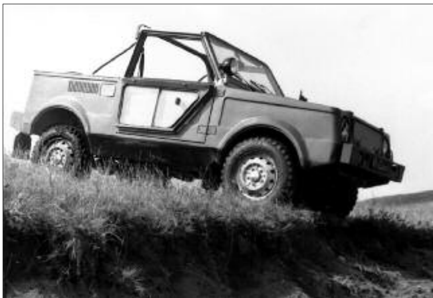
Образец третьей серии перед плавом. Передний воздухозаборник закрыт перекидной заслонкой.
