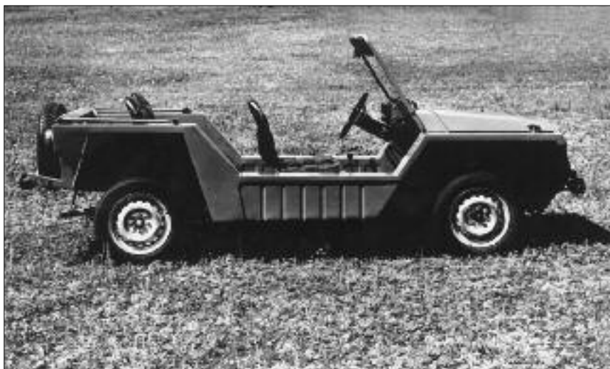
Ходовой образец "чебуроллера". Обращает на себя внимание чрезвычайно низкая посадка водителя.
