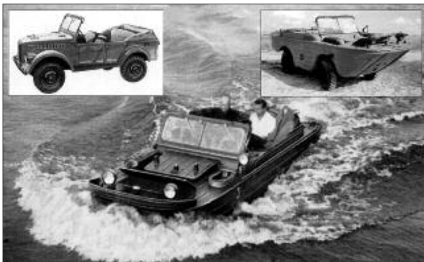
ГАЗ-46, послевоенный аналог "Форда ГПА", выполненный на агрегатах ГАЗ-69 (вверху слева), получился не столь компактным и заметно более тяжёлым.
