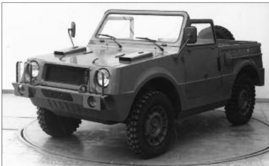
Два варианта полноразмерного макета амфибии. Выполнены целиком из дерева, включая колёса. В отличие от "чистых" амфибий, представленных выше, формы кузова являются оригинальными и самобытными (дизайнер А.Еремеев, 1974 год).
