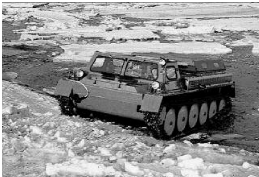
На смену ему в КЭО была разработана новая современная машина ГАЗ-71 — гусеничная амфибия центральномоторной компоновки.
