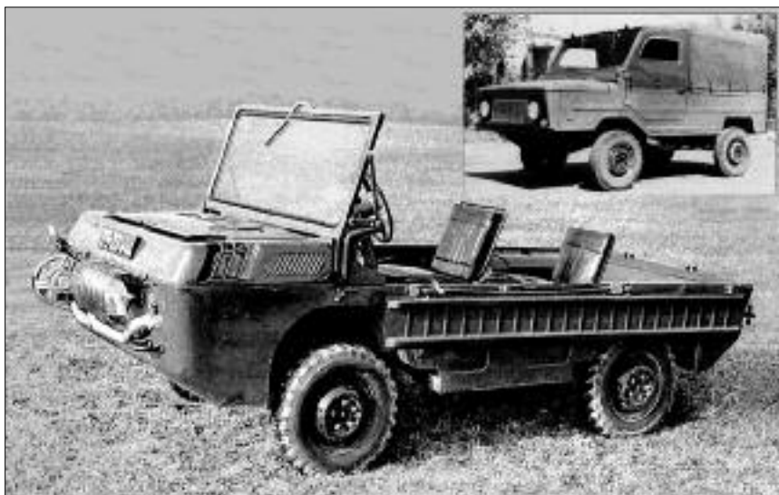
Небольшими партиями в Луцке выпускался плавающий ЛуАЗ-967 (ТПК – транспортёр переднего края) на базе известного ЛуАЗ-969 "Вольнь" – вверху справа.
