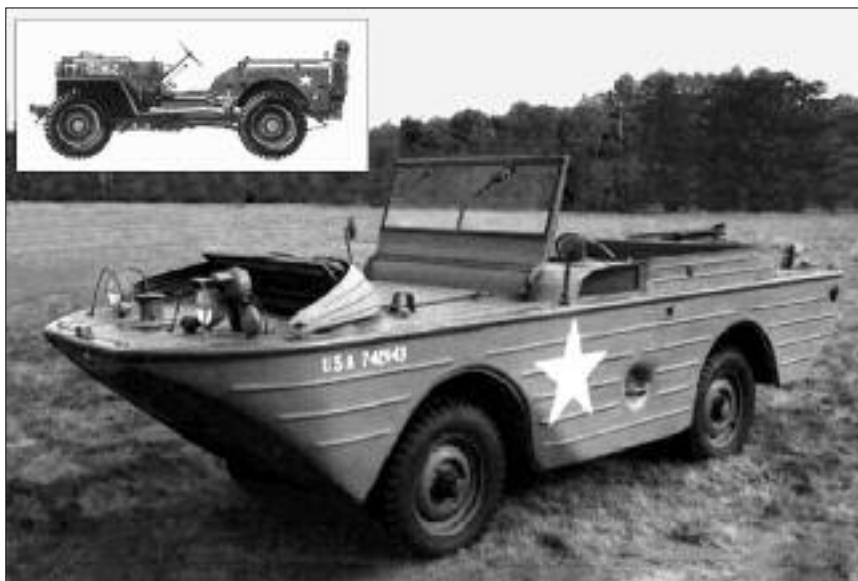
"Форд ГПА" времён второй мировой войны на базе джипа "Виллис МБ" (вверху слева).
