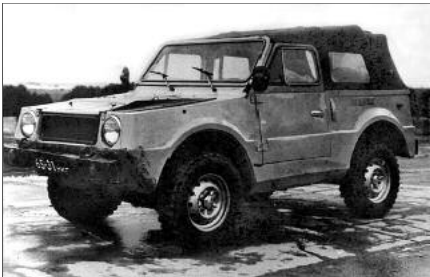
Образец второй серии на "нормальных" шинах ВЛН-6. Установлены боковые зеркала от ГАЗ-53, замки дверей заменены на серийные вазовские.
