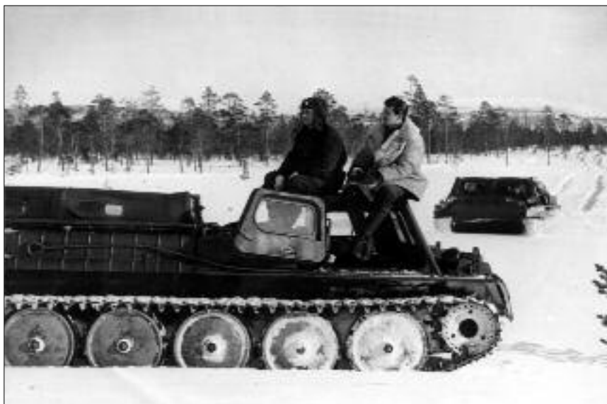
На полуметровом снегу (экипаж С.Манохов – А.Акоев). Удельное давление у нашего транспортёра – не больше, чем у лыжника (машина идёт поверху).
