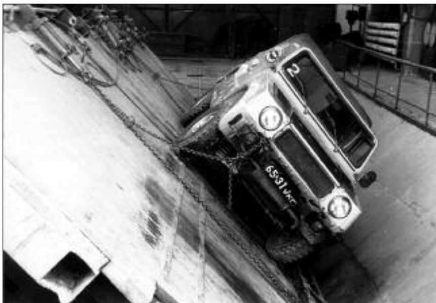
Образец второй серии на поворотной платформе в Бронницах (определение угла поперечной устойчивости).
