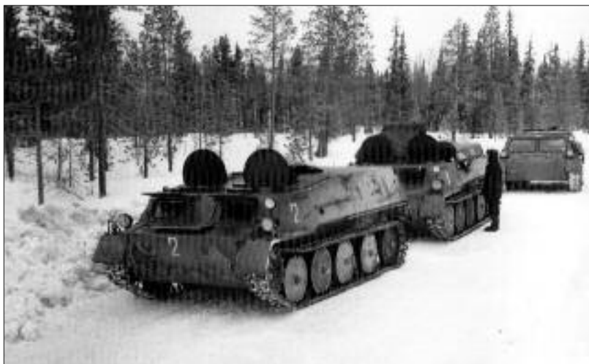
Образцы ГАЗ-73 на кольском зимнике. Впереди — цельнобронированный образец № 2, за ним — злополучный "полуброневик". Замыкает колонну ГАЗ-71.
